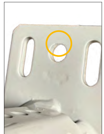
Aufhängepunkt vor Auslieferung nachgearbeitet
