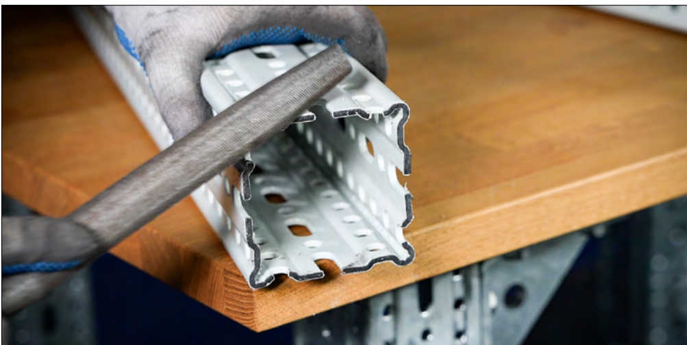
Schnittkantenbehandlung mit Handfeile
