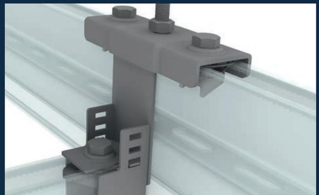
Sowohl die Montage des Installationsrasters als auch die Befestigung der Medienleitungen erfolgt mit dem Schnellmontagesystem Pressix CC. Auf einzelne Baukörperanbindungen für die Medienleitungen kann daher komplett verzichtet werden.
