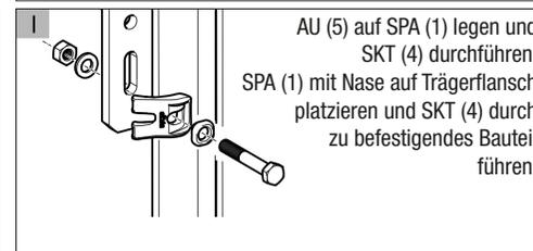
AU (5) auf SPA (1) legen und SKT (4) durchführen. SPA (1) mit Nase auf Trägerflansch platzieren und SKT (4) durch zu befestigendes Bauteil führen.
