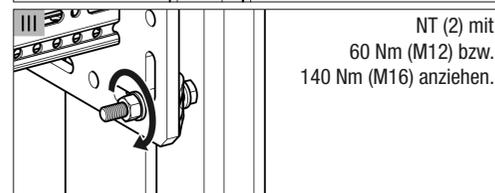
NT (2) mit 60 Nm (M12) bzw. 140 Nm (M16) anziehen.
