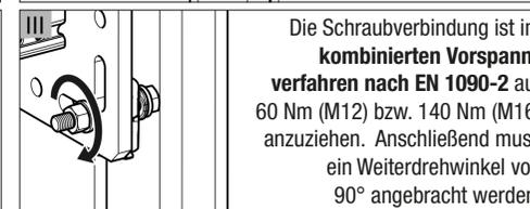
Die Schraubverbindung ist im kombinierten Vorspannverfahren nach EN 1090-2 auf 60 Nm (M12) bzw. 140 Nm (M16) anzuziehen. Anschließend muss ein Weiterdrehwinkel von 90° angebracht werden.
