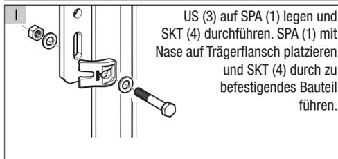
I US (3) auf SPA (1) legen und SKT (4) durchführen. SPA (1) mit Nase auf Trägerflansch platzieren und SKT (4) durch zu befestigendes Bauteil führen.
