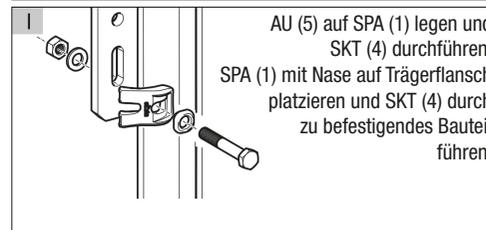
I AU (5) auf SPA (1) legen und SKT (4) durchführen. SPA (1) mit Nase auf Trägerflansch platzieren und SKT (4) durch zu befestigendes Bauteil führen.
