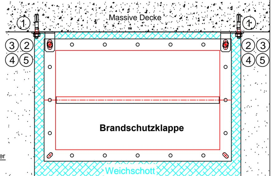
Alternativ kann jeder Anker gem. Anhang 1A und 1B verwendet werden!
